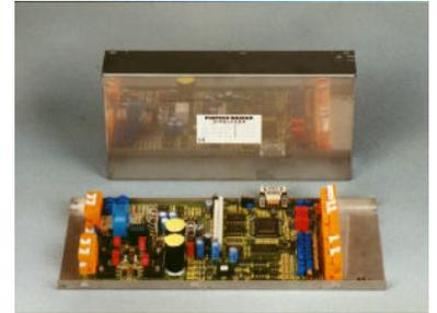
Art und Ausführung der Fahrzeugschnittstelle ist ähnlich den bereits zuvor beschriebenen Varianten bei der Zentralen Steuerung. Obige Abbildung zeigt eine mögliche technische Ausführung in einem Stahlblechgehäuse. Es stehen Ausführungen für pneumatische und elektromotorische Türantriebe zur Verfügung die jeweils applikationsspezifisch angepasst werden können. Ebenso ist eine zentrale Anbindung den Fahrzeugbus möglich.
